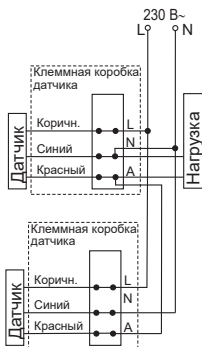
Рисунок 19 – Схема параллельного подключения датчиков
